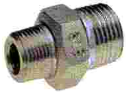
RN 6-kt.-Red. Doppelnippel R 1/8'' - 4'' , Gew. DIN 2999 auch mehrfach reduziert W.Nr. 1.4408/316
