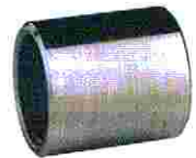
MU Muffen DIN 2986 Rp \frac{1}{8} " - 6", Gew. DIN 2999 Norm- u. Sonderlängen W.Nr. 1.4571/1.4541/4401
