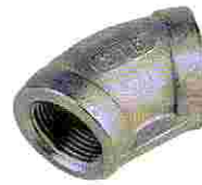
WI-45 Winkel 45° Rp \frac{1}{8} " - 4", Gew. DIN 2999 W.Nr. 1.4408/316
