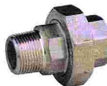
VK-IA Verschraubung kon. d. I/A \frac{1}{8} " - 4", Gew. DIN 2999/ ISO 228/1 W.Nr. 1.4408/316
