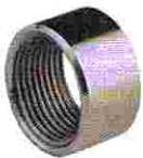
HM Halbe Muffen DIN 2986 Rp \frac{1}{8} " - 6", Gew. DIN 2999 W.Nr. 1.4571/1.4541
