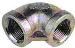
WI-90 Winkel 90°, I/I Rp \frac{1}{8} " - 4", Gew. DIN 2999 W.Nr. 1.4408/316
