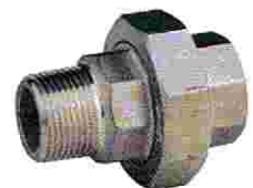
VF-IA Verschraubung fl. d. I/A \frac{1}{8} " - 4", Gew. DIN 2999/ ISO 228/1 W.Nr. 1.4408/316
