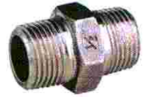
DN-6KT 6-kt.-Doppelnippel R 1/8'' - 4'' , Gew. DIN 2999 W.Nr. 1.4408/316
