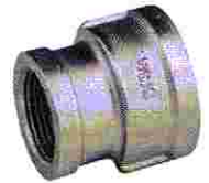
RM Red.-Muffen Rp 1/8'' - 4'' , Gew. DIN 2999 auch mehrfach reduziert W.Nr. 1.4408/316
